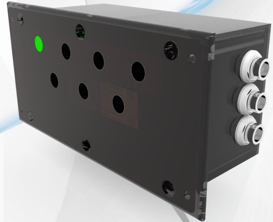
Boîtier intégrant les LED et les circuits imprimés du tableau de bord
