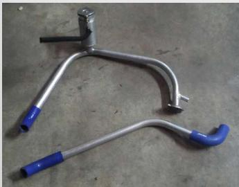
L'équipe Moteur s'est focalisée sur la réalisation des dernières pièces indispensables au roulage de la voiture tout en continuant, en parallèle, le travail de cartographie moteur. Nous avons donc réalisé le système de refroidissement et préparé les tôles du réservoir. Nous tenons également à remercier M. Luc CASTI pour la soudure de ce dernier et son travail de qualité.
