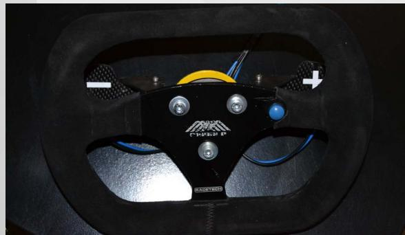
L'ergonomie de la commande d'embrayage et du montage du volant a aussi été validée. Ceci a été rendu possible grâce à un travail combiné entre départements. Le Châssis pour les palettes du volant en fibre de carbone et le département Electronique pour le câblage ainsi que les pilotes.
