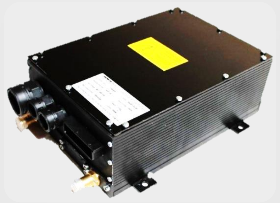
TIM600 joue à la fois le rôle d'onduleur et de contrôleur moteur
