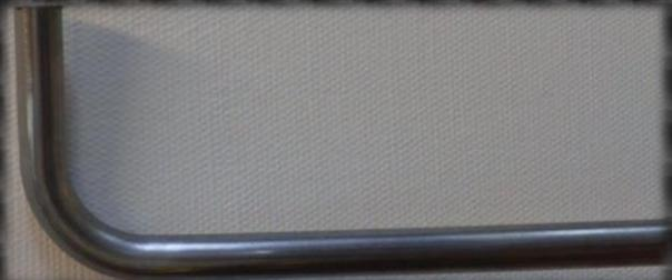
Nous avons également fait un test de cintrage de nos tubes d'échappement d'un millimètre d'épaisseur chez notre partenaire LSP: ce test a été concluant, nous réaliserons donc l'ensemble de l'échappement avec une épaisseur de tube d'un millimètre ce qui amènera un gain de poids considérable par rapport à l'échappement de TASIA 14.
